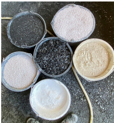
Der Kohledämmputz. 0-30mm Kohlesiebkurve, Perlit, Kalkhydrat und Hydraulkalk
